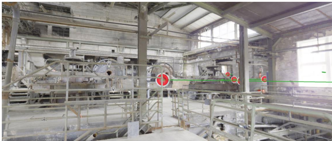
Abb_01: Panorama Laserscan der Kugelmühlen Erzbergwerk Rammelsberg (NLD/TU Braunschweig/Denkmal3D)
